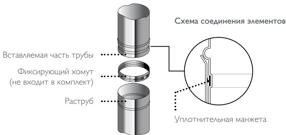
**PRIMA PLUS** — одноконтурный дымоход из нержавеющей стали. Применяется для всех видов топлива: газ, дизель, твердое топливо. Имеет линейку диаметров от 80 до 300 мм. Толщина стали составляет 0,6 мм.
