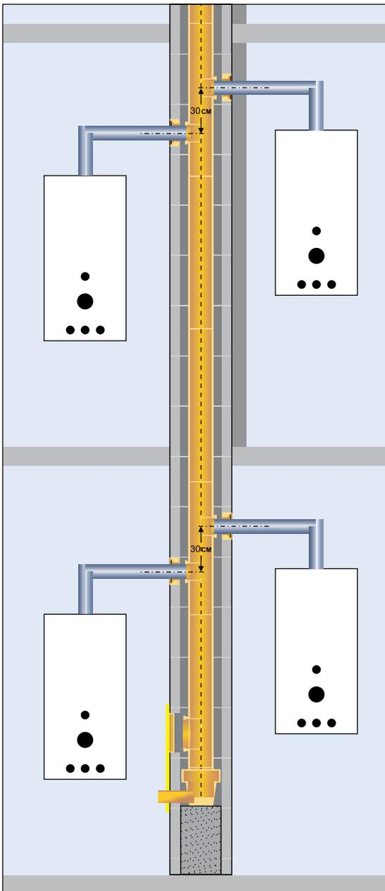
Изображённое на рисунке смещение по высоте между приборами на 30 см действительно **только для двух подключений на этаже.**
