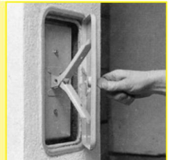
32. Удалите транспортный фиксатор с рычага дверцы и, закрывая наружную дверцу, прижмите внутреннюю часть дверцы.
