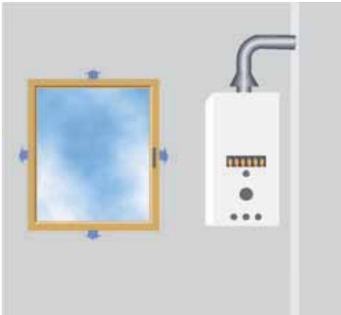
В отличие от отопительных котлов, обслуживающих целое здание, и устанавливаемых обычно в отдельных помещениях, индивидуальные газовые теплогенераторы довольно часто монтируются сегодня непосредственно в квартире. При этом должно быть гарантировано поступление достаточного количества приточного воздуха в это жилое помещение.
