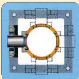
Геометрия каменной оболочки позволяет выполнять подключение со всех четырех сторон. Это означает, что на каждом этаже может быть подключено до четырёх котлов, а к дымоходу в целом до 10
