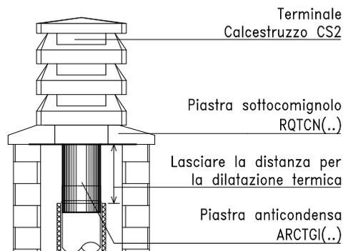
Sezione orizzontale diametri da 80 mm a 300 mm spessore parete 0,4mm
