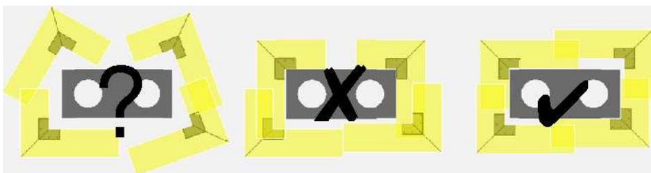
Prima di fissare la scossalina, posizionate correttamente i 4 elementi in modo da assicurare un sormonto tra i lembi di almeno **8 cm!**
