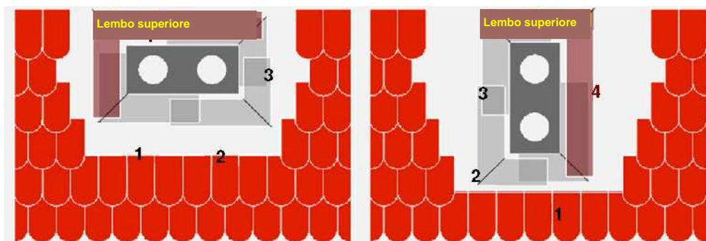
Prima di fissare la scossalina, posizionate correttamente i 4 elementi secondo la sequenza indicata, assicurandovi che il **lembo superiore** posizionato per ultimo arrivi sempre a sormontare il lato superiore del lembo nr 3!
