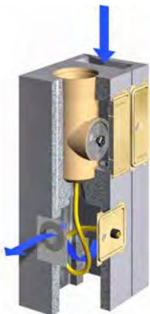
Égési levegő bevezetés a kéménylábánál
