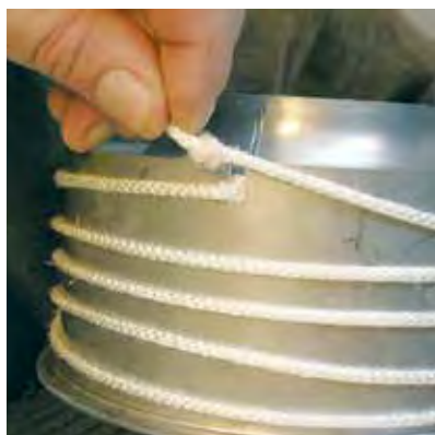
A végét a zsinórnak szintén beakasztjuk.
