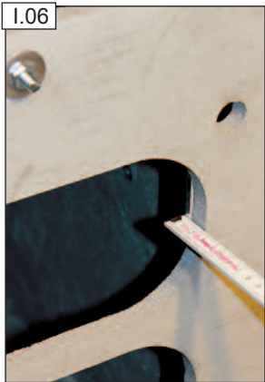
A kéményfej fedlap vastagságának mérése.
