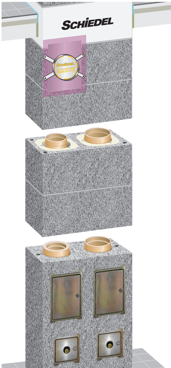
A házglehúzó összeszerelése
