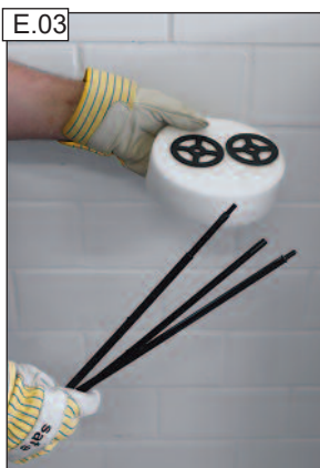
A házglehúzó összeszerelése
