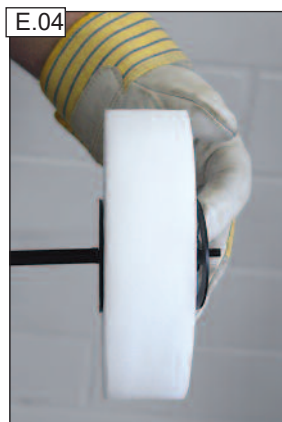
Helyezzük a lehúzó szivacsot a két alátét közé a szivacsstartós pálcára.
