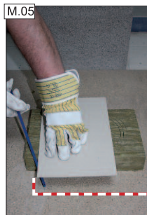
M.05 A fűrészlap segítségével vágjuk méretre az előlapot. A levágott darabot tegyük át a másik oldalra (ld. szaggatott nyíllal jelölve). A belső maggyűrűk és a mag maradjanak az előlapban merevítésként. FIGYELJEN az egyenes vágásra! MEGJEGYZÉS! Javasoljuk, hogy HSS fogazású bimetal fűrészlapot használjon a hőszigetelő előlap vágásához.
