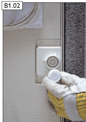
B1.02 Az ajtó kinyitásához távolítsuk el a fedőkupakot...
