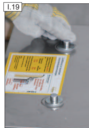
A tarkarósapkákat nyomjuk bele az BKNY csavarokba.
