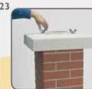
Završnu ploču pričvrstiti maticama, a preostale otvore zatvoriti plastičnim čepovima.
