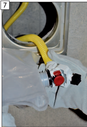
BIB-Anschlusshahn des Kondensatauffangbeutels in die Aufnahme des Kuppungsteils vom BIB-Connector einstecken.
