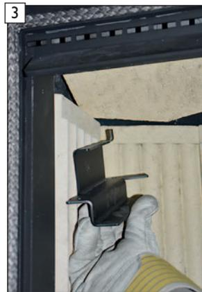
3 Den linken Kombihaltewinkel unter die obere Umlenkplatte schieben und auf der Seitenverkleidung der Brennkammer auflegen.
