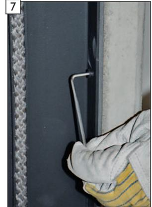
Mit Inbusschlüssel alle Befestigungsschrauben am Brennammerrahmen vollständig zurückschrauben.
