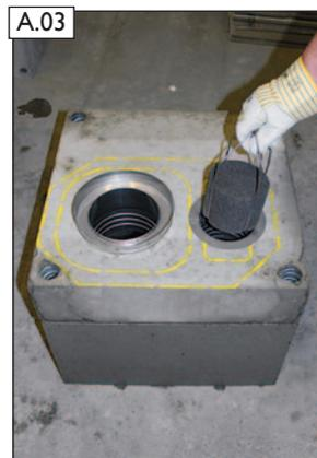
Unteren Schutzschwamm Zuluft (2) in Zuluftstutzen einstecken.
