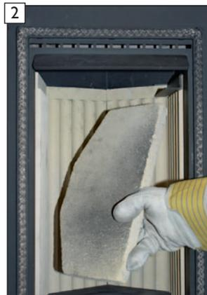
2 Obere Umlenkplatte steil über dem Kombihaltewinkel einführen und quer drehen.
