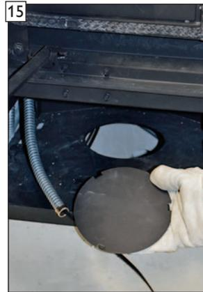
Revisionsdeckel am Gehäuseboden der Brennkammer herausnehmen.
