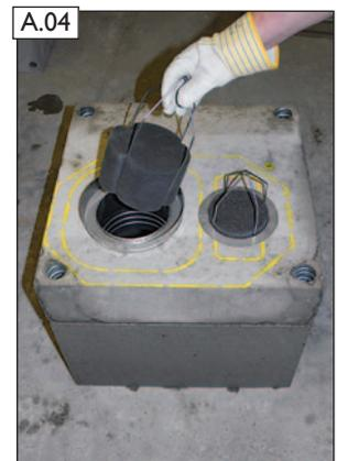
Unteren Schutzschwamm Abgas (1) in Montagetrichter einstecken.
