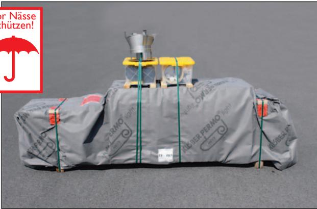
Das KINGFIRE-Ofenmodul wird mit einer diffusions-offenen Feuchteschutzabdeckung angeliefert. Diese Schutzabdeckung darf erst unmittelbar vor dem Versetzvorgang entfernt werden.
