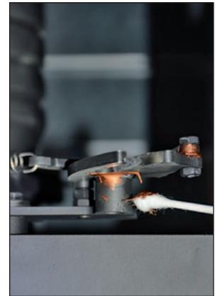
Gelenkschraube oben mit etwas Kupferpaste nachschmieren.
