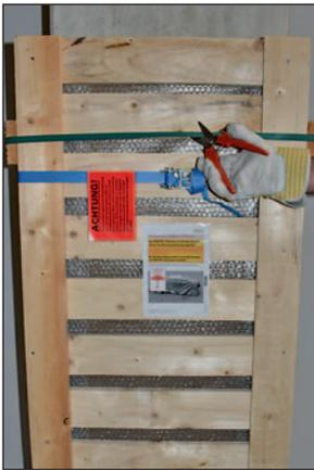
1. Beide grünen Verpackungsbänder entfernen und **unteren** Spanngurt öffnen.
