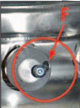
Verbindungselement für Druckmessschlauch und ggf. notwendige Kupferringe zur richtigen Positionierung der Fixierschraube des Verbindungselementes dicht in die vordere Öffnung des Abgasadapters einschrauben.
