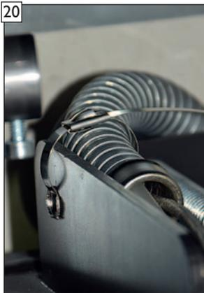
20 Eine entsprechende Bohrung ist hierzu an einem Metallsteg an der Brennkammer vorhanden.
