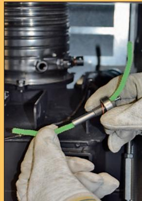
Messkanal des Verbindungselementes von innen reinigen.
