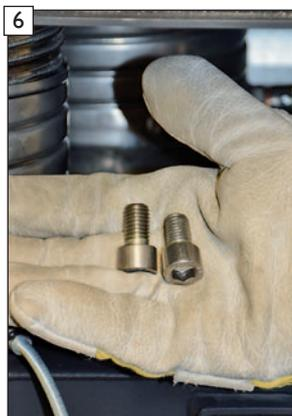
Die beiden Edelstahlverschlusschrauben M12 werden zur weiteren Montage nicht mehr benötigt.
