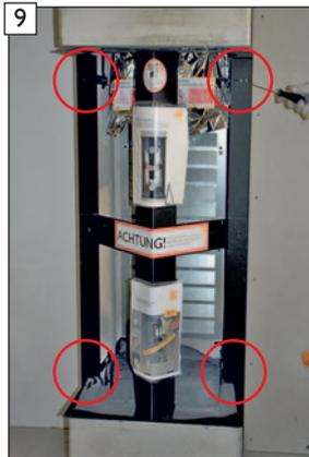
Umlaufend alle Verstellerschrauben des Haltewinkels am Montagerahmen leicht lösen.
