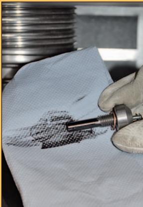
Verbindungselement von außen reinigen.
