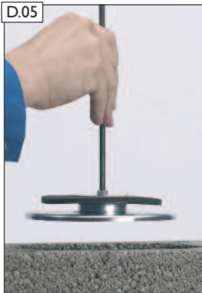
D.05 Fugenschutzdeckel mit Magnet am Fugenglätter abnehmen.
