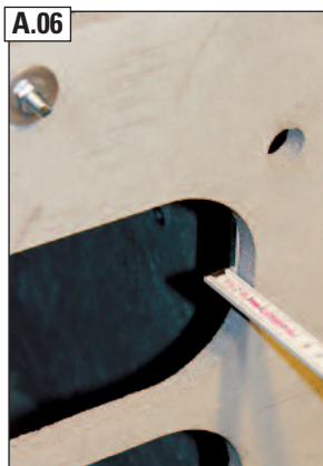
A.06 Ermittlung der Aufbauhöhe.
