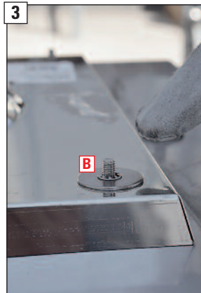
3 Sicherungsscheibe (B) auflegen und ...
