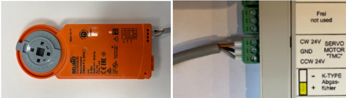
**Defekte Motoren werden von der Steuerung erkannt und als Klartext- Fehlermeldung auf dem Display angezeigt. Bei Kingfire, die kein Display haben, blinkt die Funktions-LED dann schnell, etwa 2 x pro Sekunde. Dies ist nicht zu verwechseln mit dem langsamen Blinken (1 x pro Sekunde) bei der Meldung zum Nachlegen.**
