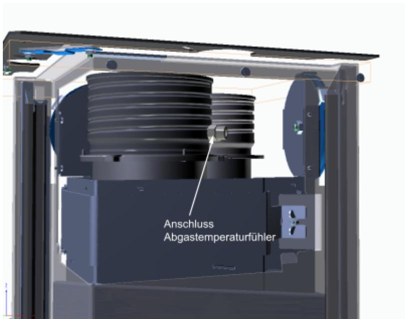
Die Anschlussleitung wird zur Steuerung verlegt und dort an die Anschluß-klemme „K-Type“ angeschlossen. Polarität beachten ! Montage: Fühlerkabel ohne Anschlussklemme hinter dem Strahlungsblech durch den montierten Metallschlauch nach unten fädeln.
