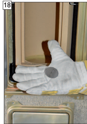
18 Grobfilter aus der Ablauföffnung im Kondensatteller herausnehmen und reinigen. WICHTIG! Rußablagerungen dabei ggf. vorher aus dem Kondensatteller entfernen!
