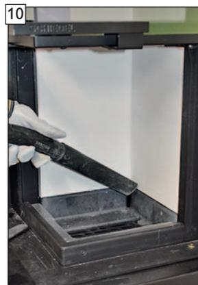
10 Brennkammer im oberen und unteren Bereich gründlich reinigen.
