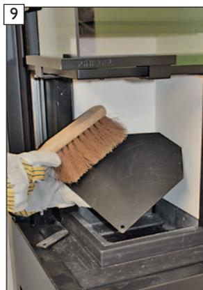
9 Obere Metallumlenkplatte anheben, aus der Brennkammer entfernen und mit Handfeger reinigen.
