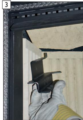
3 Den linken Kombihaltewinkel unter die obere Umlenplatte schieben und auf der Seitenverkleidung der Brennkammer auflegen.
