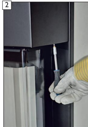
Seitliche Fixierschrauben der Frontverkleidung lösen.
