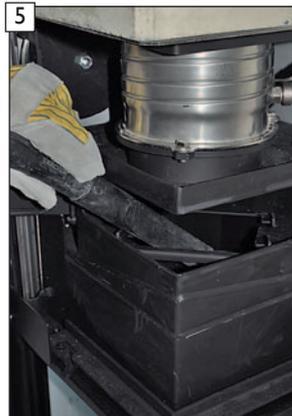
5 Vorreinigen der Oberseite der Metallumlenkplatte.
