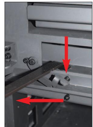
Den Arretierungsbolzen bei leicht geöffneter Feuerraumtür nach oben klappen. Bei vollständig geöffneter Feuerraumtür klappt dieser wieder selbstständig zurück.
