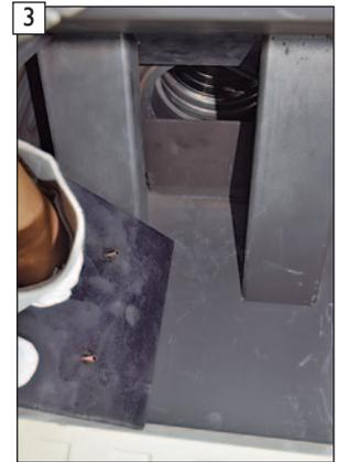
Untere erste Metallumlenkplatte leicht anheben, drehen und aus der Brennkammer entfernen.
