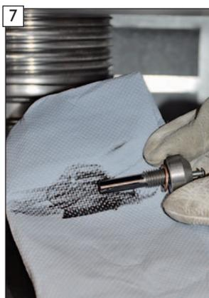
7 Verbindungselement von außen reinigen.
