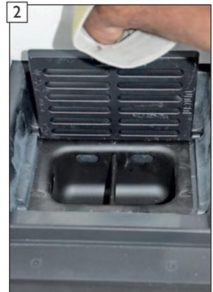
Klapprost in die hinteren Vertiefungen der Bodensteine einsetzen.
