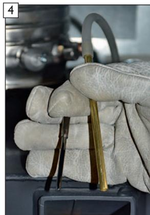
4 Temperaturfühler und Messingröhrchen aus den Anschlusschrauben entfernen.
