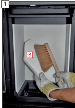
Die vordere (B) und hintere (A) Prallplatte leicht anheben, aus der Brennkammer entfernen und mit Handfeger reinigen. Die Reinigung der 2-teiligen Prallplatte nach Bedarf, mind. aber 1x pro Jahr vornehmen.
