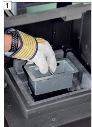
Aschekasten in die Bodenöffnung der Brennkammer einsetzen.
