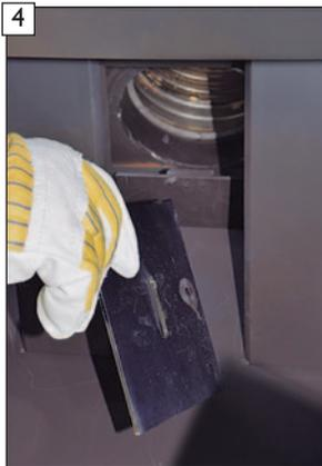
Zweite obere Metallumlenkplatte nach vorne aus dem Halteblech herausziehen.
