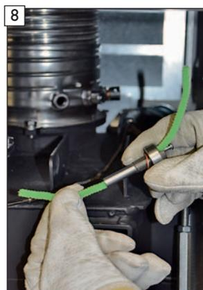
8 Messkanal des Verbindungselementes von innen reinigen.
