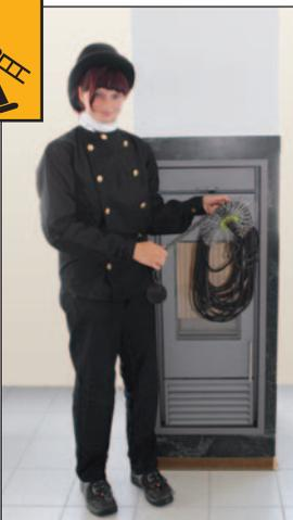
Um die empfindlichen Oberflächen der Verbindungselemente zu schützen und einen Rosteintrag zu verhindern darf die Reinigung der Abgasanlage mit keramischen Innenrohr und der eingebauten Edelstahl-Verbindungselemente zur Brennkammer im Feuerstättenteil nur mit einem Edelstahlbesen erfolgen.
