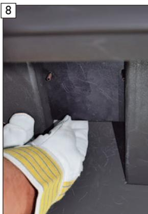
Untere Metallumlenkplatte wieder einsetzen und in die Aufnahmelaschen einrasten.
