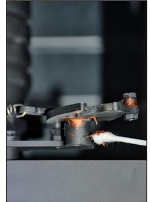
Gelenkschraube oben mit etwas Kupferpaste nachschmieren.
