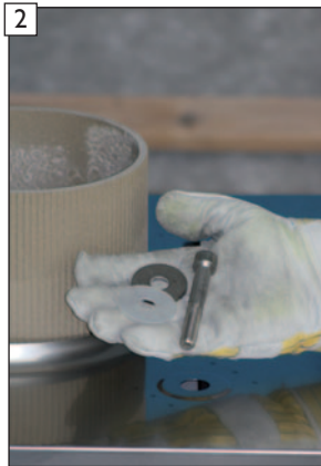
Montagereihenfolge: 1. Silikondichtungen 2. Edelstahl-Unterlegscheiben 3. Edelstahl-Inbusschrauben M12
