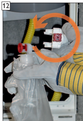
Verriegelung des BIB-Connectors (Drehung gegen den Uhrzeigersinn) öffnen und BIB-Anschlussahn mit dem Kondensatauffangbeutel aus dem Kupplungsteil heraus- ziehen.
