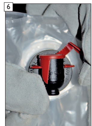
6 Siegel am BIB-Anschlusshahn entfernen.
