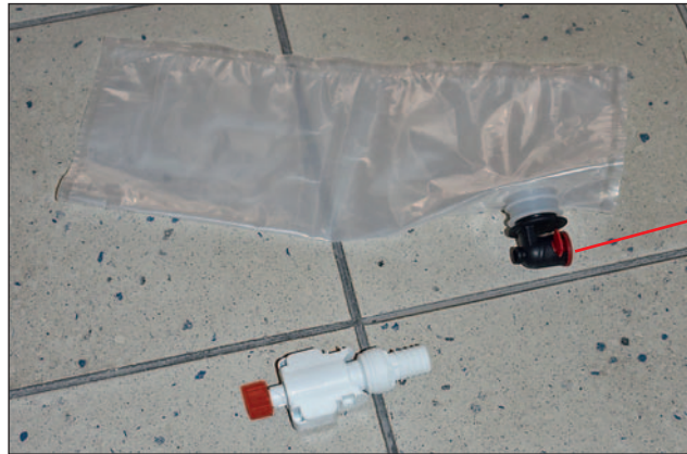
Detaildarstellung Siegelverschluss BIB-Anschlusshahn
