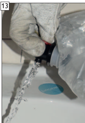
Durch Drücken der Entrie- gelung (rote Entriegelungs- taste) am BIB-Anschluss- hahn kann der Kondensat- auffangbeutel tropfsicher enleert werden.
