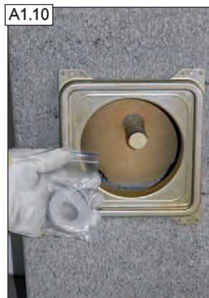
BlowerDoor Dichtset aus dem Fertigfußpaket entnehmen und ...
