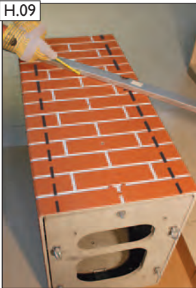
Der erforderliche Schrägschnitt kann nun allseitig auf dem Stülpkopf angezeichnet werden.
