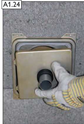
BlowerDoor Türblatt mit Dichtgummi auf das montierte HT-Rohr aufschieben, einhängen und verschließen.
