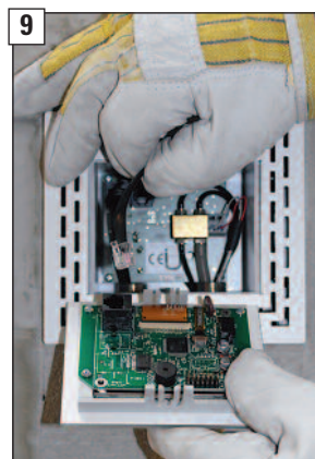
Steckverbindung mit der LUC-Displayeinheit verbinden.
