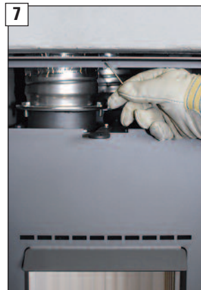
7 Mit Inbusschlüssel alle Befestigungsschrauben am Brennkammerahmen vollständig zurückschrauben.
