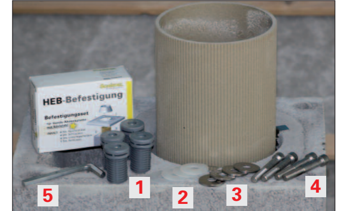
Inhalt Befestigungsset HEB-Zuluftkopfplatte-Edelstahl: 1 - HEB-Spezialdübel (4 Stück) 2 - Silikondichtungen (4 Stück) 3 - Edelstahl-Unterlegscheiben (4 Stück) 4 - Edelstahl-Inbusschrauben M12 (4 Stück) 5 - Inbusschlüssel
