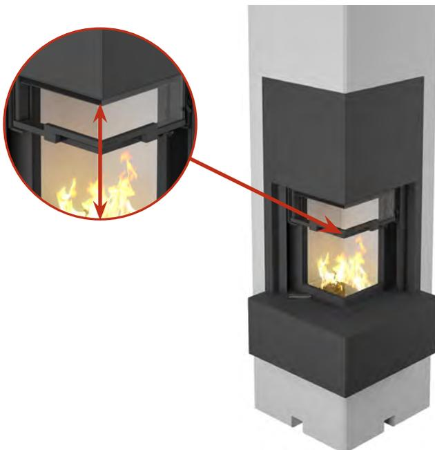
Die leichtgängige Schiebetür des KINGFIRE® KANTO SC ist die moderne Alternative zur Schwenktüre. Die Türe wird beim Öffnen nach oben geschoben und versenkt sich elegant hinter der Designverkleidung. Somit wird beim normalen Betrieb kein zusätzlicher Platz für einen Schwenkradius in den Wohnraum benötigt und die Asche bleibt beim Nachlegen im Brennraum.
