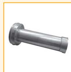
Napojovací díl přes zeď se zděří Tloušťka materiálu: 1,0mm Délka: 500mm Materiál: 1.4404, tl. 1,0mm
