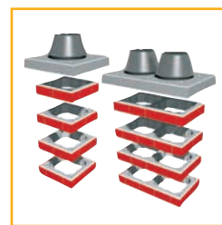
Kominové ukončení FINAL (vzhled lícového zdiva kominového tělesa vytvoří kominové prvky FINAL.)
