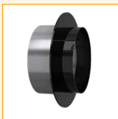
Napojovací díl křbová kamna oboustranný Materiál: 1.4404, tl. 1,0mm Barva: černá žáruvzdorná
