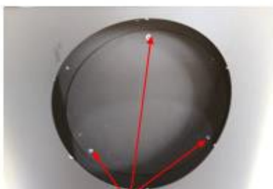
Vyvtání otvorů průměr 6 mm
