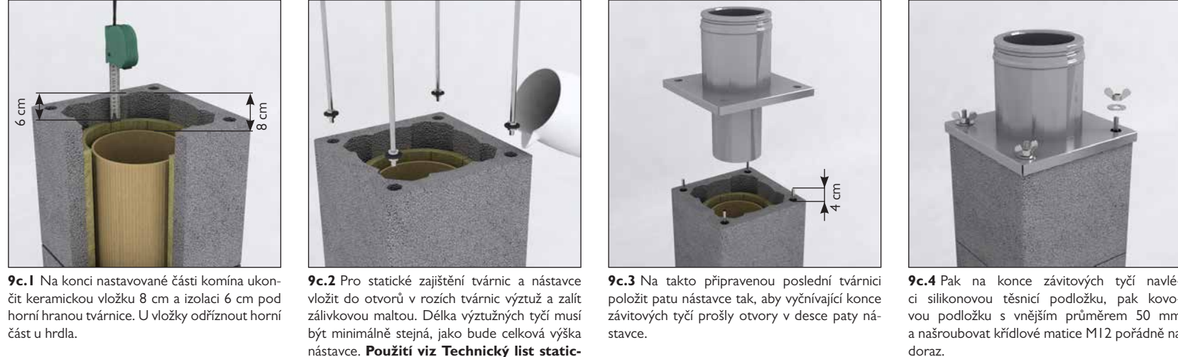
9c.1 Na konci nastavené části komína ukončit keramickou vložku 8 cm a izolací 6 cm pod horní hranou tvárnice. U vložky odříznout horní část i hrdla. 9c.2 Pro statické zajištění tvárnice a nástavce vložte do otvorů v rozích tvárnice vývězu a zalit zátkovou maltou. Délka výtvarných tyčí musí být minimálně stejné, jako bude celková výška nástavce. Použijte viz Technický list statického zajištění. Viz zadní strana. 9c.3 Na takto připravenou poslední tvárnici položte patu nástavce tak, aby vytvářel konce závěsných tyčí projevy otvory v desce paty nástavce. 9c.4 Pak na konce závěsných tyčí navlečte silikonovou těsnící podložku, pák kovovou podložku s vnějším průměrem 50 mm a nastrobovat křídlovou maticí M12 pořádně na doraz.
