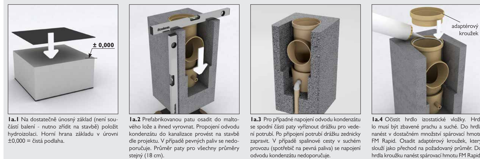
1a.1 Na dostatečně ušný základ (není součástí balení - nutno zřídit na stavbě) položit hydroizolaci. Horní hrana základu v úrovni ±0.000 = čista podlahy. 1a.2 Prefabrikovanou patu osadit do maltového lože a ihned vyrovnat. Připojení odvodu kondenzátu do kanalizace provést na stavbě dle projektu. V případě pevných paliv se nedoporučuje. Spárovací hmotu se nanáší do odlišného hrdla, hrdlo musí být zvané prachu a suché. 1a.3 Při případném napojení odvodu kondenzátu se spodní část paty vyřiznout drážkou pro vedení potrubí. Po připojení potrubí drážku zednicki zaplnit. V případě spalování v suchém provozu (spotřebič na pevná paliva) se napojení odvodu kondenzátu nedoporučuje. 1a.4 Očistit hrdlo izostatické vložky. Hrdlo musí být zbavené prachu a suché. Do hrdla nanést v dostatečném množství spárovací hmotu FM Rapid. Osadit adaptérový kroužek, který slouží jako přechod na požadovaný průměr. Do hrdla kroužku nanést spárovací hmotu FM Rapid.
