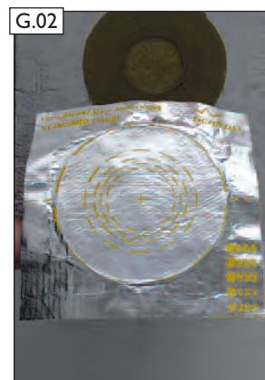
Pohled na přední stranu IGNIS-PROTECT BlowerDoor krytu s vyznačením polohy vnitřních segmentů.
