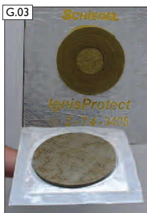
Pohled na zadní stranu IGNIS-PROTECT BlowerDoor krytu s okolními lepicími pásky pro utěsnění na hliníkové fólii prostupu IGNIS-PROTECT.
