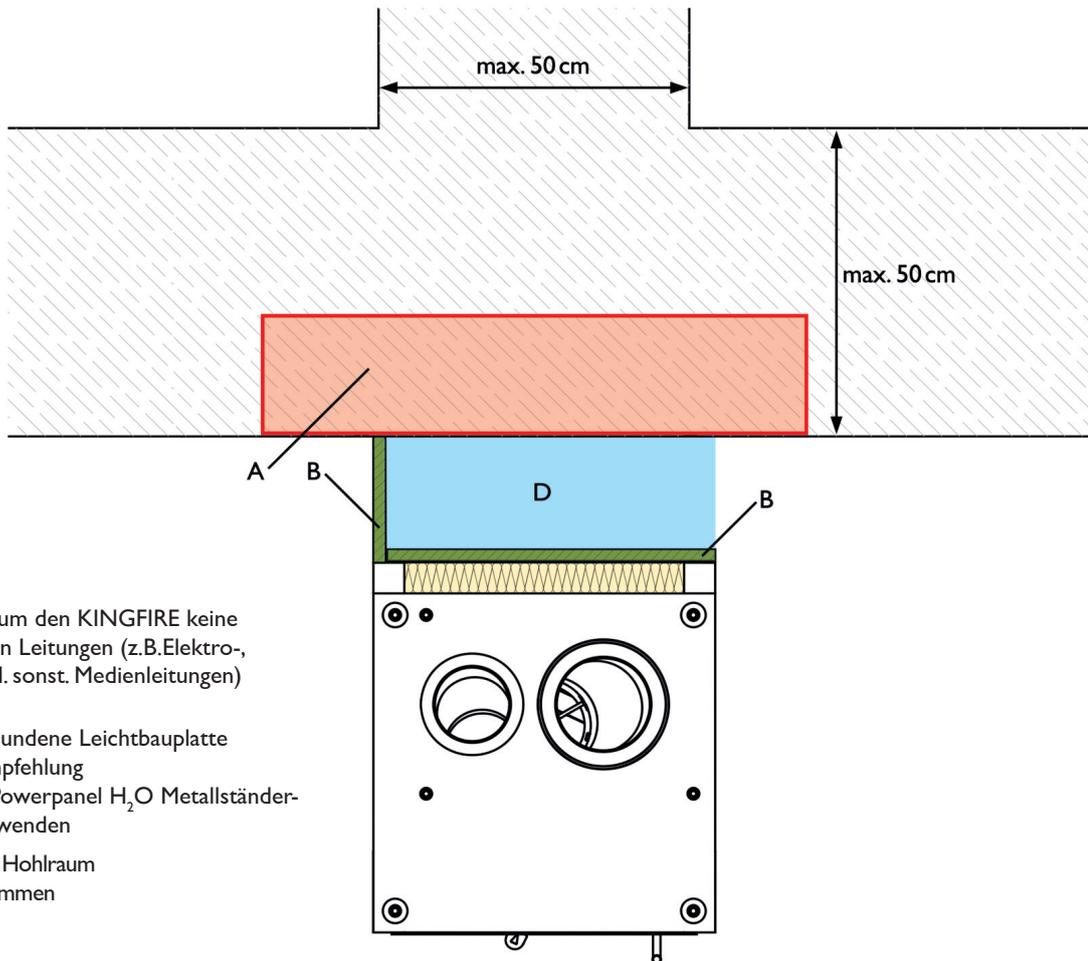
A - bis 20 cm um den KINGFIRE keine brennbaren Leitungen (z.B. Elektro-, Wasser od. sonst. Medienleitungen) verbauen.
