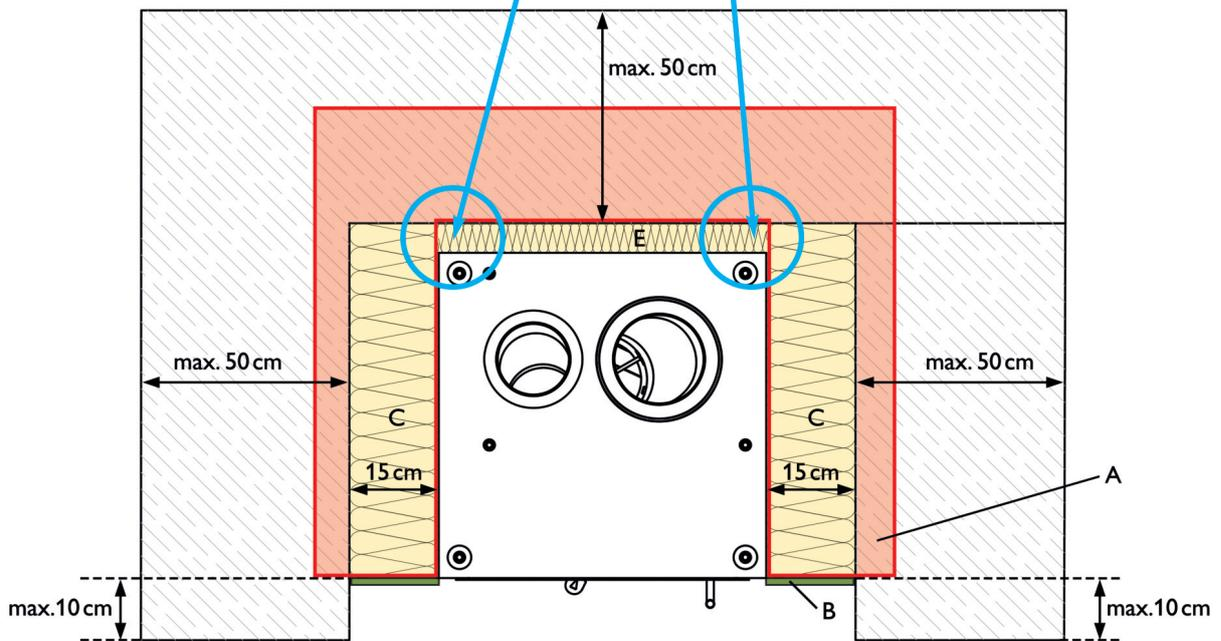
A - bis 20 cm um den KINGFIRE keine brennbaren Leitungen (z.B. Elektro-, Wasser od. sonst. Medienleitungen) verbauen.
