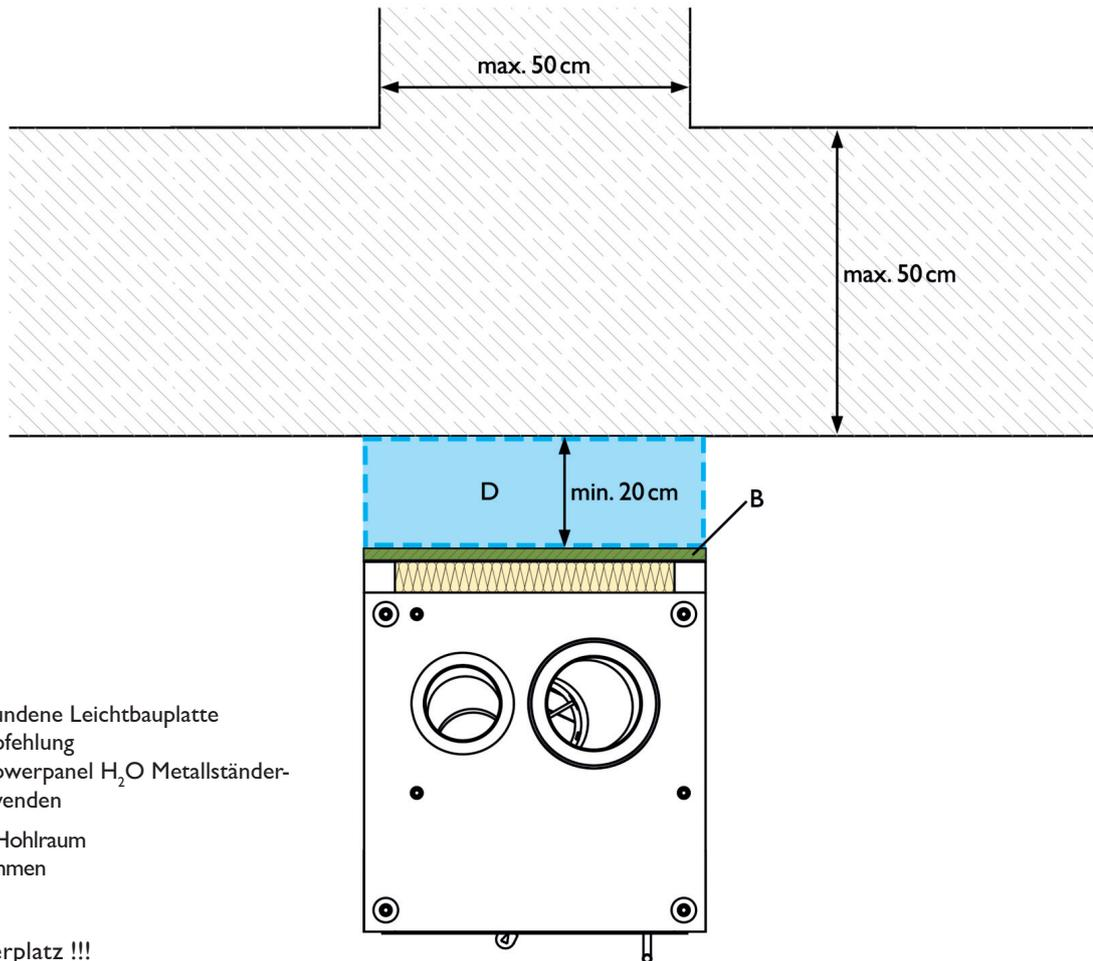
B - zementgebundene Leichtbauplatte
