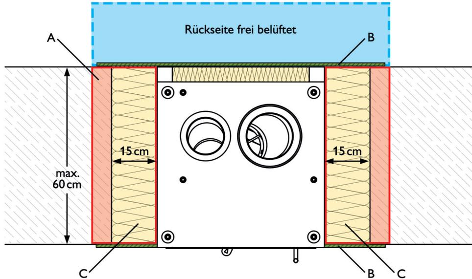
A - bis 20 cm um den KINGFIRE keine brennbaren Leitungen (z.B. Elektro-, Wasser od. sonst. Medienleitungen) verbauen.
